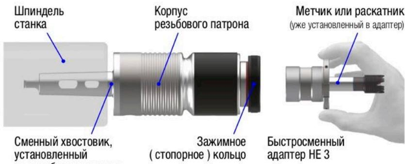
2. Поверните зажимное (стопорное) кольцо, как показано на рисунке, таким образом, чтобы быстросменный адаптер смог зайти внутрь посадочного отверстия резьбового патрона.
