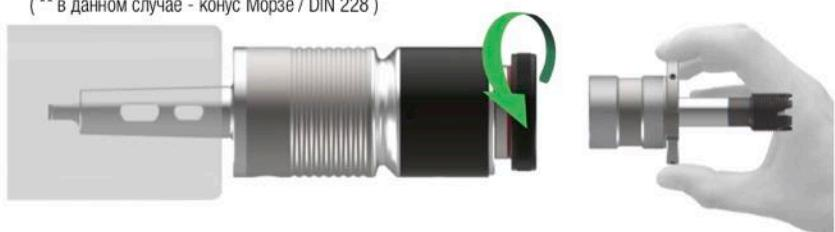
3. Вставьте быстросменный адаптер с уже установленным в нём инструментом внутрь резьбового патрона.
