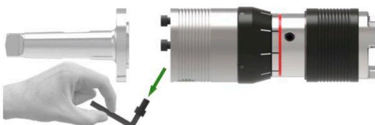
1. С помощью ключа снимите все крепёжные болты, установленные на резьбовом патроне в месте присоединения хвостовика.
