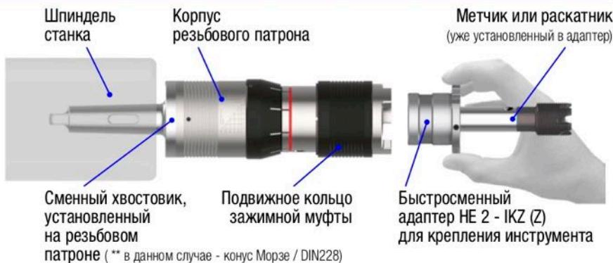
2. Сместите подвижное кольцо зажимной муфты в направлении хвостовика резьбового патрона до упора и удерживайте его в таком положении.
