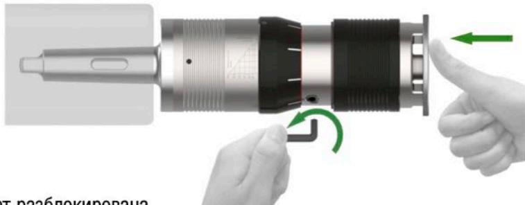
4. Перестаньте удерживать резьбовой патрон в сжатом положении (отведя назад шпиндель станка и/или перестав удерживать опорную плитку).
