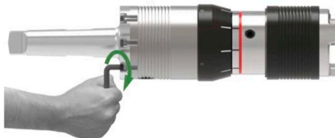
2. Присоедините хвостовик к резьбовому патрону и равномерно затяните все крепёжные болты.
